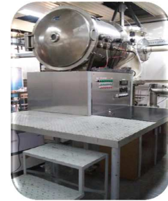
Reator grande para DLC (800 litros DLC litros de volume)
