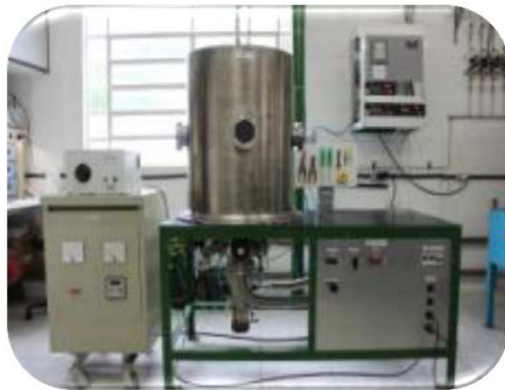
Reactor médio para DLC (20 litros de volume )
