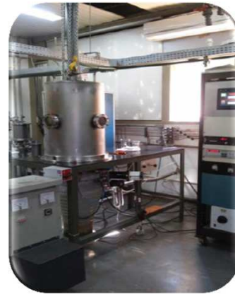
Reator médio para DLC (120 litros de volume)
