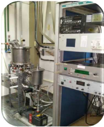
Reactor pequeno para DLC (20 litros de volume )
