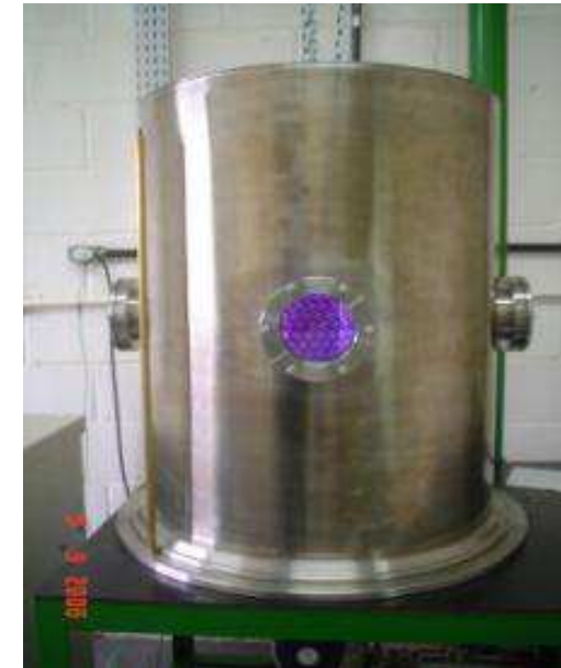
Câmara para crescimento de DLC com catodo adicional em alto vácuo ( 10^{-6} mbar)
