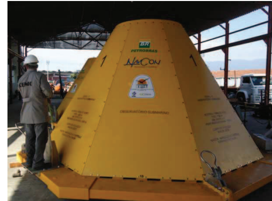
Módulos para testes de vazamento de óleo em plataformas submersas (material compósito)
